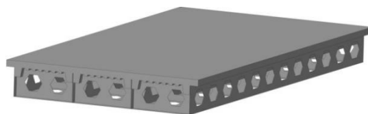
Рис. 8. Фрагмент запропонованої сталезалізобетонної прогонової будови
