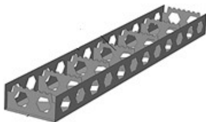
Рис. 10. Металевий блок СТЖБ прогонової будови
